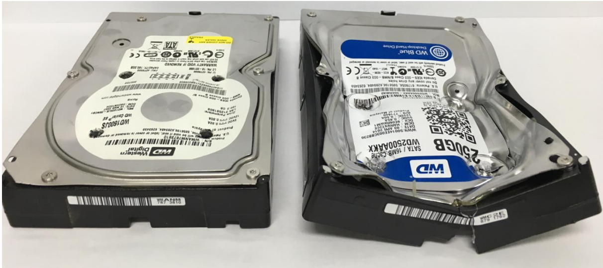
■ 写真左 通常の穿孔破壊 4か所に穴あけの処理が施される
