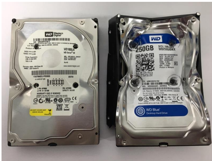
■ 写真左 通常の穿孔破壊 4か所に穴あけの処理が施される
