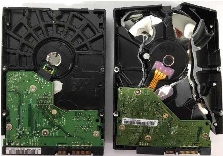
■ 写真左 通常の穿孔破壊 基盤や裏面のダメージが無い
